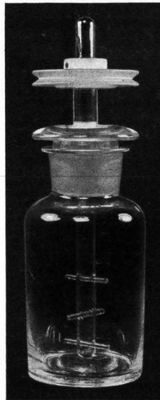
Bild 21. Rührwerk, vollkommen aus Glas hergestellt.
