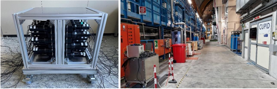
Abb. 10: links: Am KIT realisierter Aufbau des Detektors aus 36 Plastiksintillatormodulen, die abwechselnd von Photomultipliern (mit Seriennummern der PMTs und der zugehörigen Spannungsteiler) links und rechts der Module ausgelesen werden. Die Module samt PMTs befinden sich in einem mobilen Rahmen aus Bosch-Profilen. Im Bild sind die Seitenwände noch offen, die im LNGS (Abb. rechts) mit Blei-Platten eine Abschirmung gegen Gamma-Untergrund bilden. Rechts: Messposition (im Bild links vorne) im LNGS in der Nähe des CUPID-Experiments zur Suche nach Dunkler Materie. Detektorsystem mit PMT-Spannungsversorgung und der Datenaufnahme-Elektronik auf der Deckplatte der Szintillatormodule.
