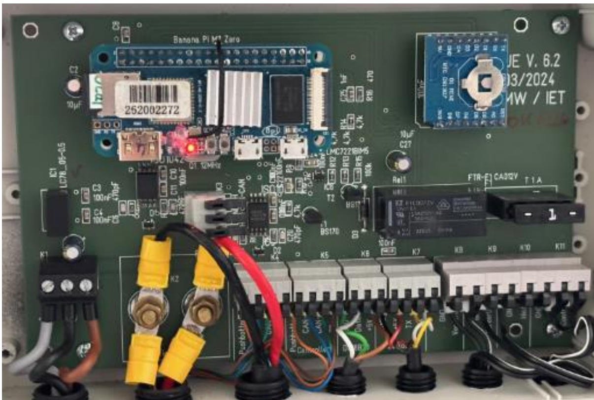
Abbildung 2.1.1: Platine der UE-Ped und Mikrocontroller
