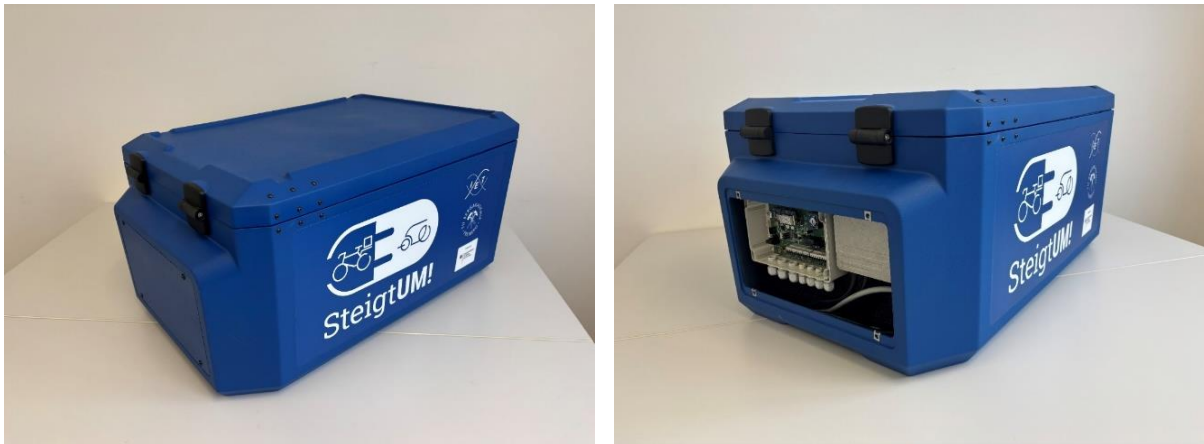
Abbildung 2.1.2: Sattelseitige Ansicht der Transportbox des CityPed®. Im rechten Bild ist in der geöffneten Transportbox links die UE-Ped und rechts der Motorcontroller (ECU) der Fa. Heinzmann zu erkennen
