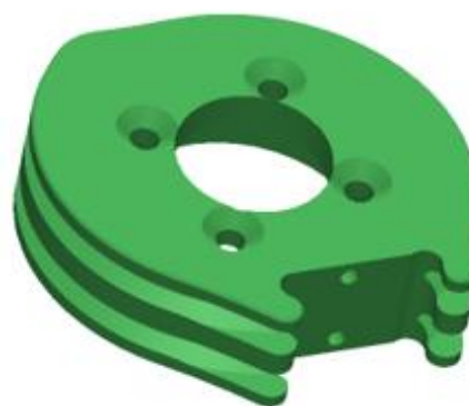
Abbildung 2.2.16: links Prüfstand zur Untersuchung der Kettenumlenkung; rechts additiv gefertigte Kurvenseilrolle
