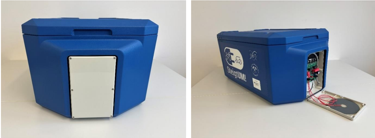
Abbildung 2.3.7: Transportbox mit integriertem Sekundärsystem des induktiven Ladens, links geschlossen, rechts mit Spulensystem im Deckel
