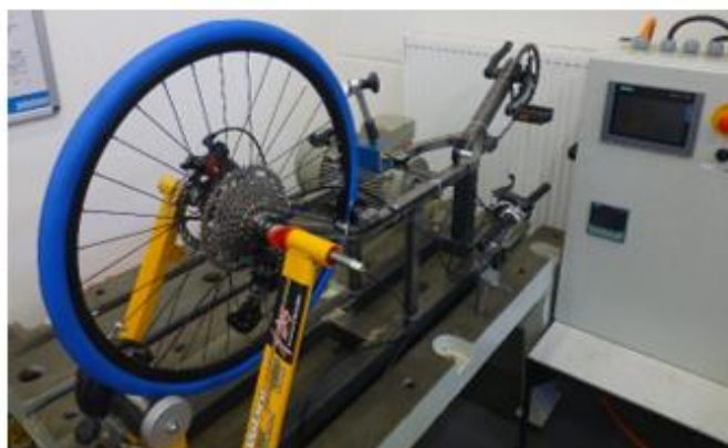
Abbildung 2.2.16: links Prüfstand zur Untersuchung der Kettenumlenkung; rechts additiv gefertigte Kurvenseilrolle
