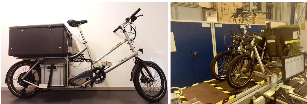
Abbildung 2.2.2 links: präpariertes Messfahrrad; rechts: Flachbahnprüfstand
