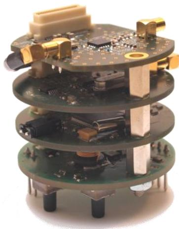
**Abbildung 2.27** IHPStack, ein modularer Sensorknoten für Prototypenentwicklung.
