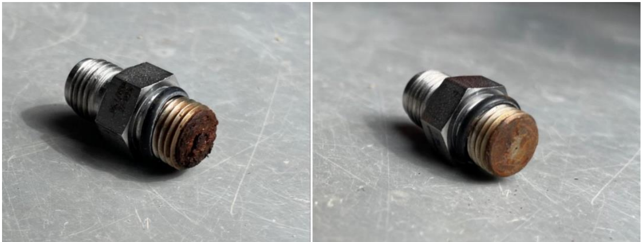
Abbildung 5: Ablagerung an Orifice
