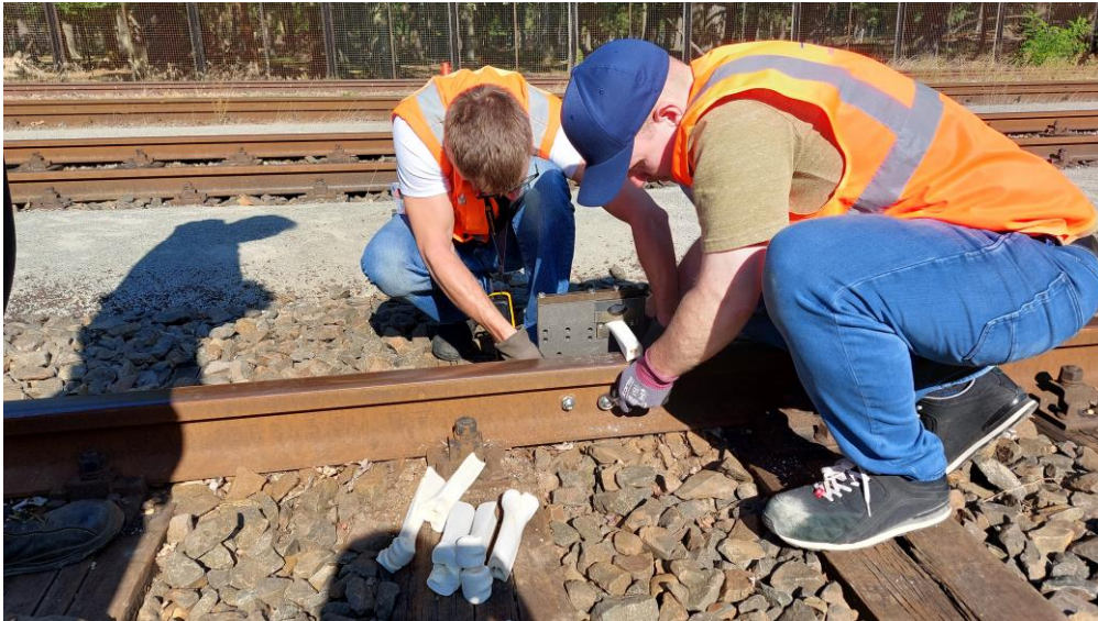
Abbildung 6.8: Befestigung von Knochen für den Überrolltest.
