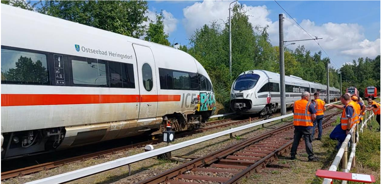
Abbildung 6.9: Kupplungsversuche, der aTL fuhr auf einen zweiten ICE auf, um einen Aufprall nachzubilden.
