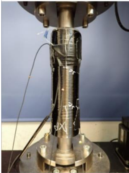
Abbildung 4: Fiber-Bragg-Probekörper und aufgenommenener Dehnungsverlauf. Durch Störungen springt das Signal extrem.
