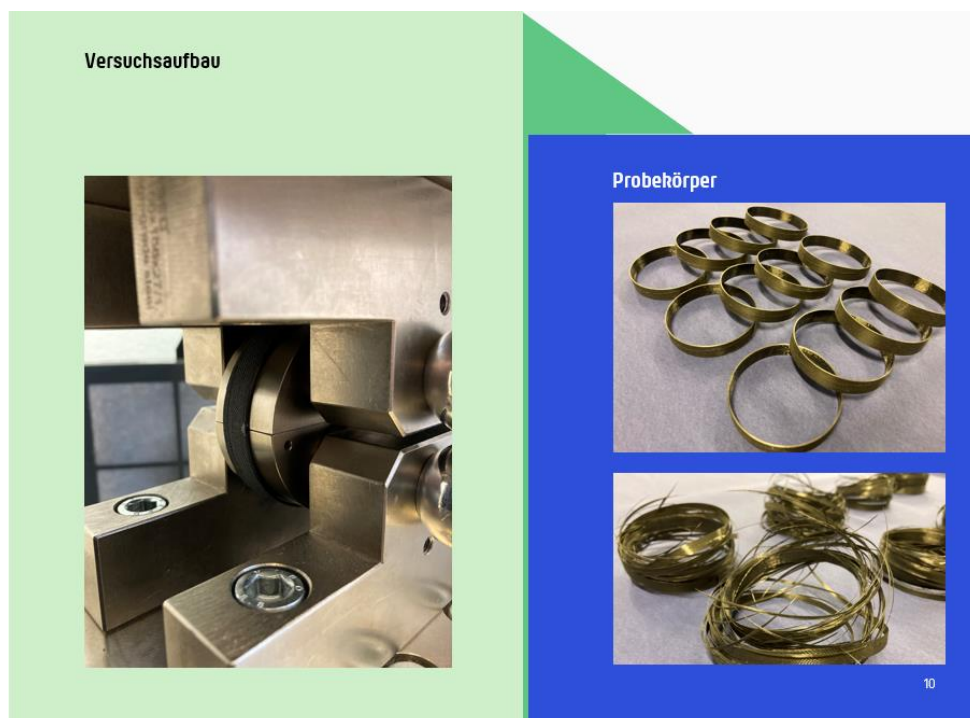
Abbildung 9: Bei mefex hergestellte NOL-Ringe vor und nach der Prüfung.
