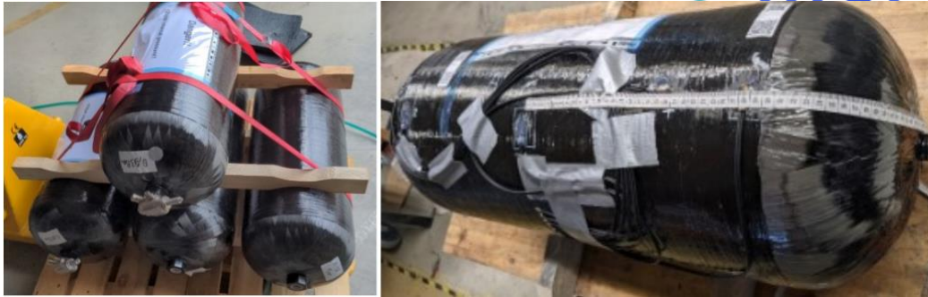
Figure 1: Behälter vor und nach der Sensorapplikation bei mefex. Dehnmessstreifen wurden aufgebracht und für die Messung bei Hexagon vorbereitet.
