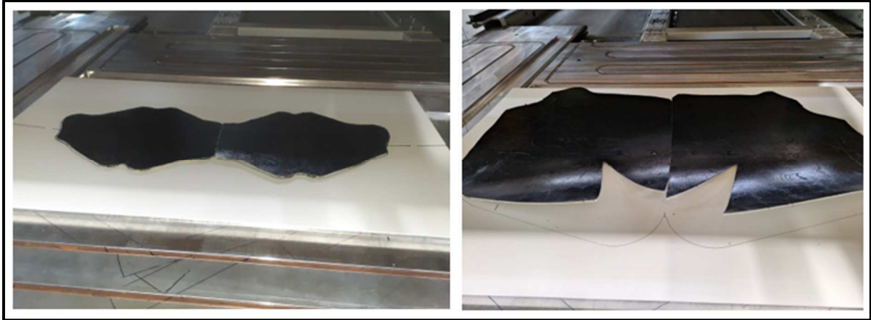
Abbildung 4.27: Zuschnitte mit Ultraschallschweißpunkten fixiert/ 08.01.25 Lakowa intern.
