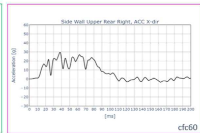
Abbildung V1.5: Messpunkte Seitenwand (rot, grün, lila) mit zugehörigen Beschleunigungswerten bei ECE R137 Frontalaufprall aus dynamischer Simulation
