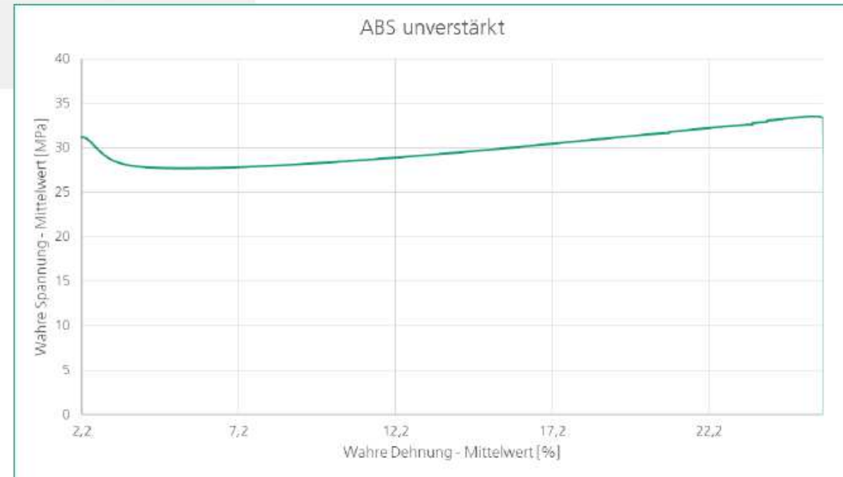
Verfestigungskurve - Wahre Spannung vs. Wahre Dehnung
