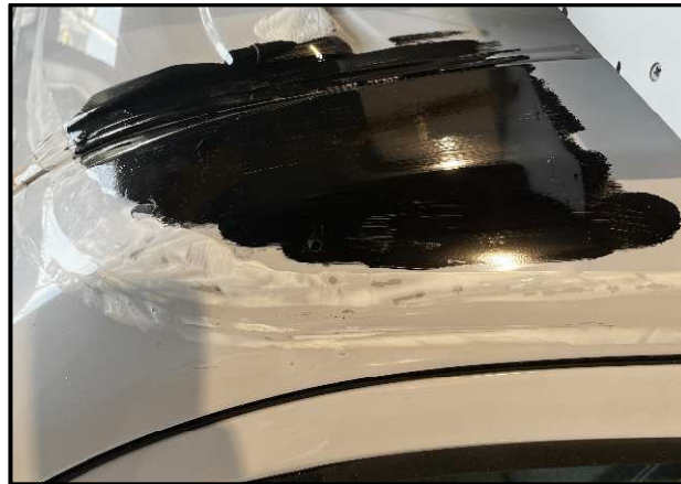
Abbildung 6.1 Zu sehen ist der Primer-Auftrag an der linken Fahrzeugseite (schwarz auf weißem Lack). Das Foto zeigt den Bereich und die zu primernde Fläche, wie sie beim Prototyp vorbereitet wurde.
