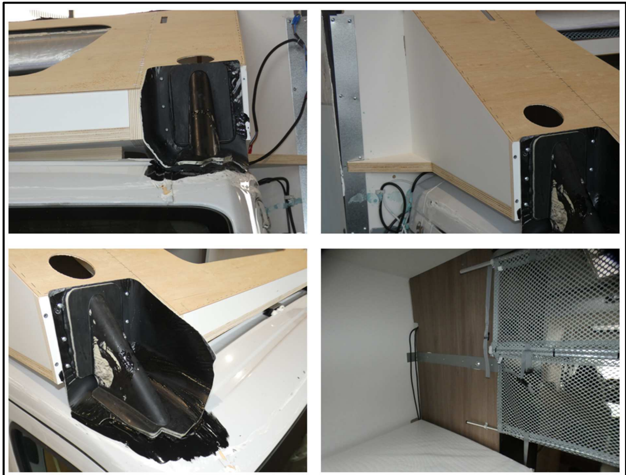
Abbildung 6.2: In der Abbildung sind vier exemplarische Bilder vom Aufbau des Demonstratorfahrzeugs gezeigt. Die Bilder oben links, oben rechts und unten links zeigen den montierten Zustand des Versteifungswinkels aus unterschiedlichen Blickwinkeln. Im Bild unten rechts ist darüber hinaus gezeigt, wie das Fahrzeug zusätzlich für den Fahrzeugtest modifiziert werden musste, um die empfindliche Messtechnik im Crashversuch zu schützen.
