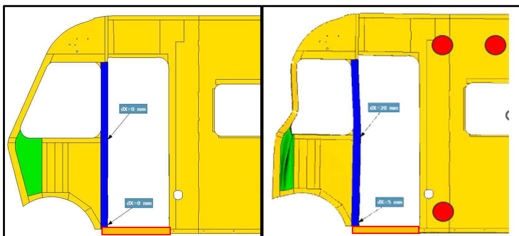
Abbildung V1.11: „Knautschzone“ faltet sich gezielt zusammen und absorbiert Energie
