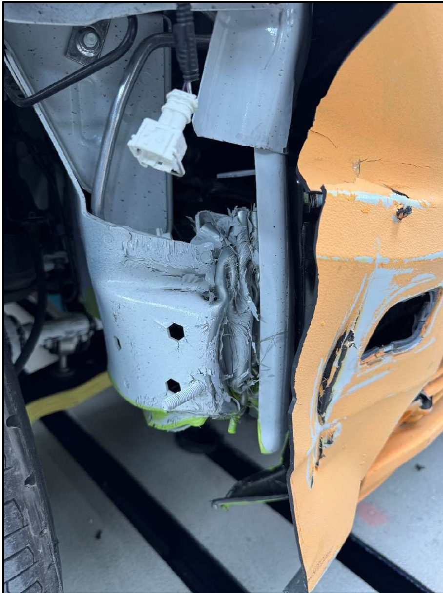
Abbildung V1.9: Verformungen beim Crashtest des Teilintegrierten T68 nach ECE R137 – die Stahlstruktur des Ducato faltet sich gezielt zusammen.
