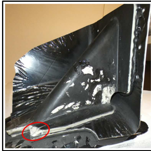
Abbildung 7.9: Seitenansicht des Verstärkungswinkels nach dem Abschleifen der zur Kollision führenden Ecke (rot eingekreist).
