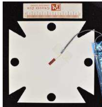
Abb. 11: Probekörpergeometrie (li./ mi.) und exemplarische Darstellung des Schubversuches DIN EN ISO 20337: Einspannung an der Prüfmaschine (re.)
