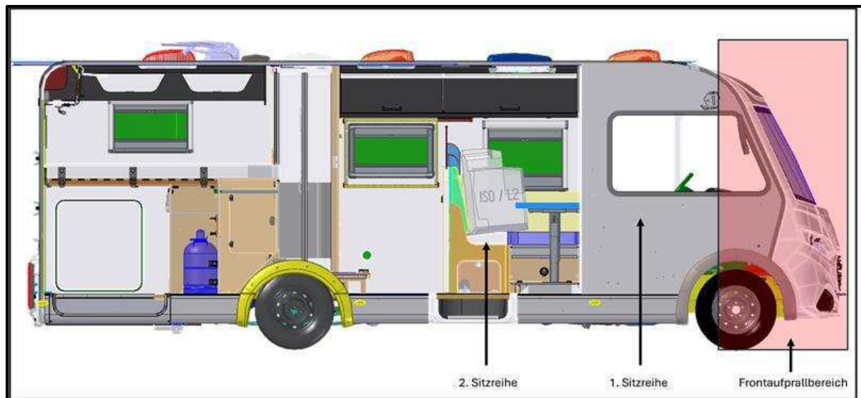
Abbildung V1.1: Schnittdarstellung eines vollintegrierten Reisemobils. Die erste und zweite Sitzreihe sind gekennzeichnet und der direkte Wirkungsbereich des Aufpralls bei einem Frontaufprall (rot).
