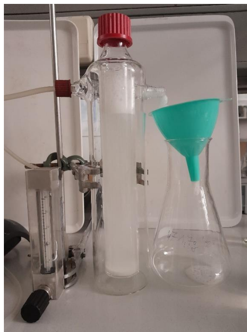
Abbildung 32: Laborapparatur zur Optimierung der Schaumflotation
