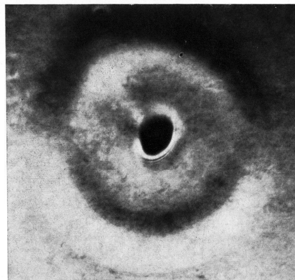
Bild 18. Ausbildung einer „Aureole“ um ein Sandkorn nach mehrstündiger thermischer Exposition bei 1150^\circ , sichtbar gemacht im Schlierenmikroskop nach Einbettung in Immersion. Es handelt sich um eine echte Inhomogenität an der Oberfläche, nicht etwa um eine Wulstbildung, als welche sie dem Auge erscheint. Sie tritt als Folge besonderer Diffusionsvorgänge auf. Oben: Anfangsstadium. Der Hof liegt noch eng an dem Sandkorn. Unten: Fortgeschrittenes Stadium. Der Ring löst sich mit wachsendem Durchmesser vom Sandkorn ab.
