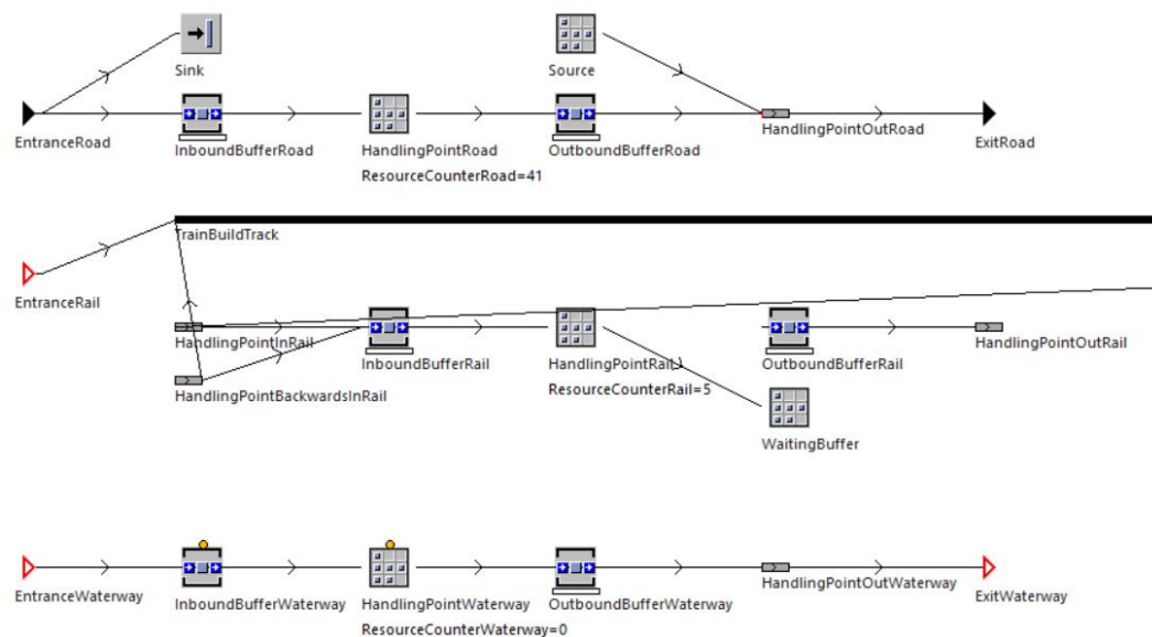
Abbildung 13: Aufbau der Black Box für Hafenaerale
