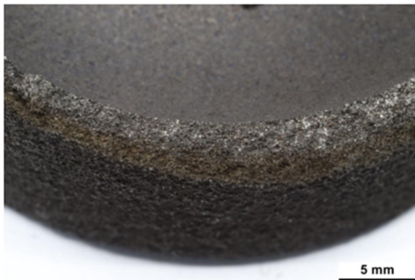
Abbildung 6: künstlich erzeugte Bruchfläche durch die Filterkappe
