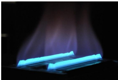
Abb.33: Doppelschlitzbrenner: Foto der HMDSO beladenen Propan-Flammen
