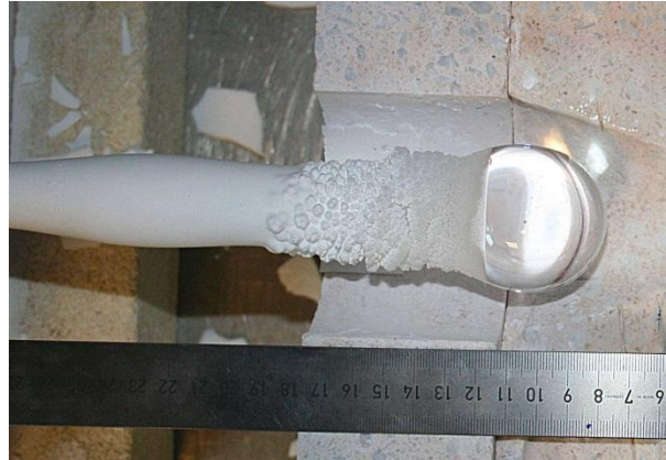
Abb.17: In der Muffel der Direktabscheidungsanlage hergestelltes synthetisches Quarzglas (Brennermuffel geöffnet)
