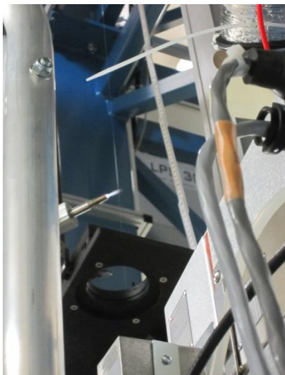
Abb. 21: In beiden Abbildungen ist dargestellt, wie der Plasmabrenner der Fa. Tigres von links eine senkrecht verlaufende Glasfaser beschichtet.
