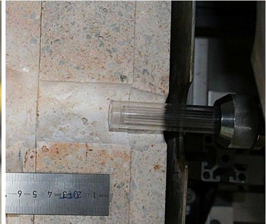
Abb. 11: Brenner aus konzentrischen Glasrohren wie er für die Direktabscheidung von Quarzglas eingesetzt wurde
