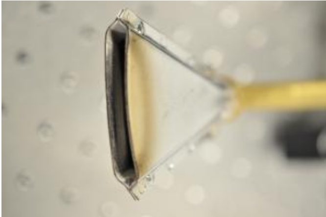
Abb. 10: SURA-Handbrenner für SiO 2 -Beschichtung mit TMS (PYROSIL®-Coating von SURA Instruments)
