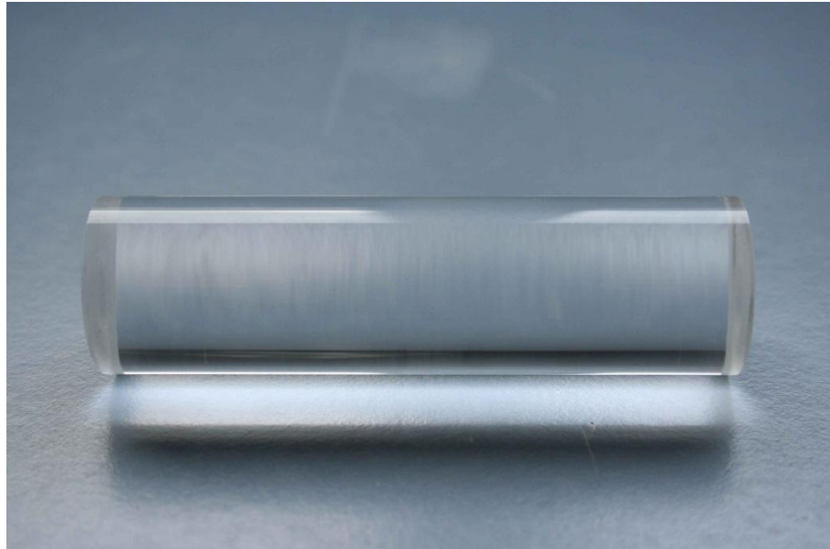
Abb. 50: Für das Ziehen einer optischen Faser vorbereiteter Zylinder aus dem Bor-dotierten Quarzglas DS78
