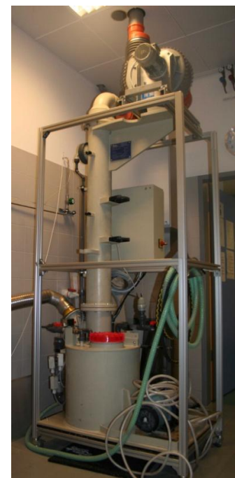
Abb. 13: Gaswäscher für die Behandlung der Abgase aus der Direktabscheidung
