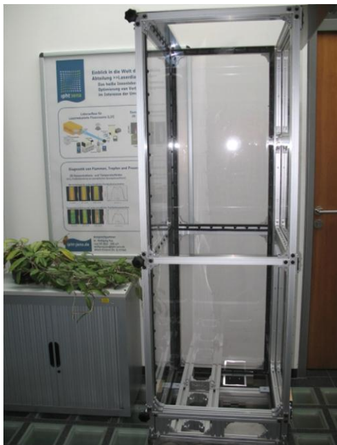
Abb. 5 Einhausung des Verbrennungsmessplatzes für Messungen an Partikel-beladenen Flammen mit speziellen Zuluft-Öffnungen in der Grundplatte.
