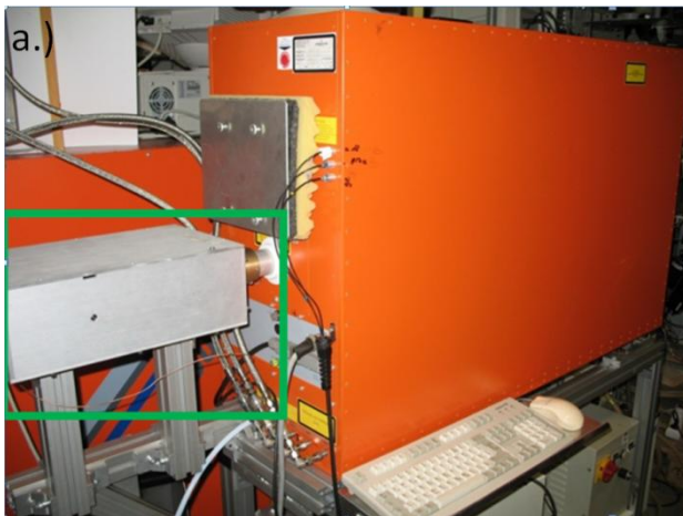
Abb. 1a: Transportables Lasersystem mit Schmalbandeinheit (grüner Rahmen)
