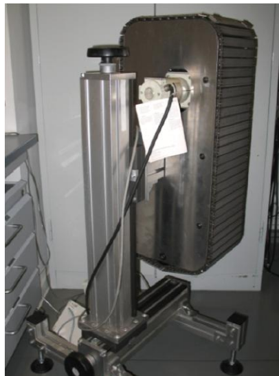
Abb. 4: Gliederbandförderer für die Flammen-/Plasmabasierte \text{SiO}_2 -Beschichtung.
