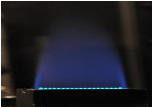
Abb. 24: Lochbrenner: Foto der Propan/Luft-Flamme
