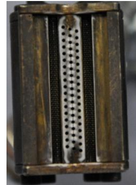
Abb. 9: Lochbrenner mit 1 mm Lochdurchmesser, 1,75 mm Lochreihenabstand, 50 mm Breite
