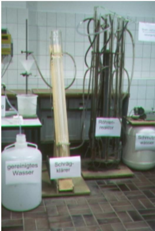
**Abb. 26 a:** Kontinuierlich arbeitender Elektrolyselaborreaktor mit Röhrenschrägklärer
