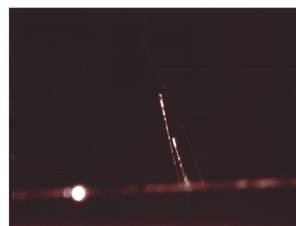
Als Einzelfaser zwischen Si-Wafer geklemmt, überstehende Fasern gemessen.
