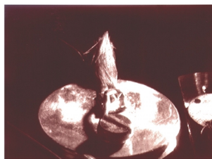
Als "Pinsel", an einem Ende mit Al-folie umwickelt, Messung am überstehenden Ende.
