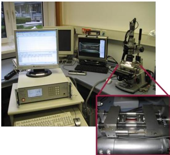
Abb. 28: Mit dem Keyence VHX-Lichtmikroskop gekoppeltes Zug-Druckmodul mit symmetrischer Probenauslenkung . Das Detail zeigt einen Teil des Zug-Druckmoduls mit eingespannter Probe des skalierten Probentyps 1B.
