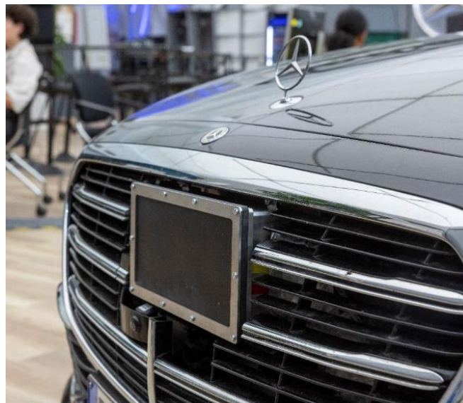
Abbildung 1: Infineon Radar Sensor, verbaut in einem PKW von Mercedes-Benz
