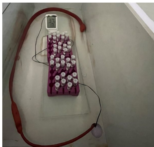
Abbildung 5: Klimakammer mit Heizschlange (rot), Temperatursensor und Probengläsern. Die Proben im hinteren Halter befinden sich in SBF4 und im vorderen Halter in SBF1.
