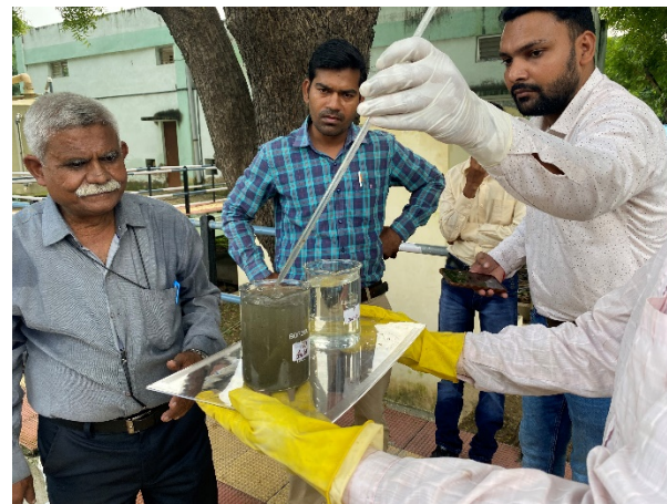
Abbildung 17 Vergleich Zulauf (li.) und Ablauf (re.)
