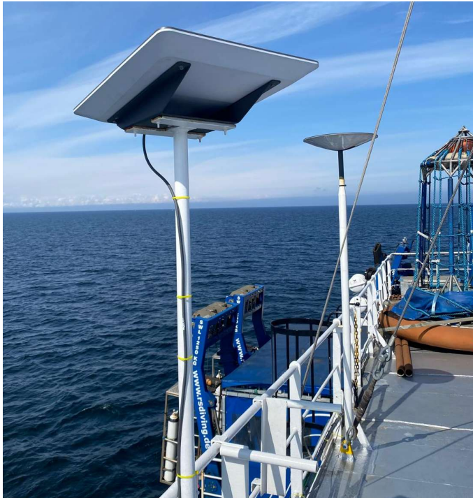
Abb. 4 Starlink-Antennen an Bord der RS Sentinel
