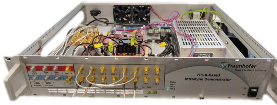
Abbildung 100: Aufbau der FPGA-Hardware für den P2MP-Systemdemonstrator
