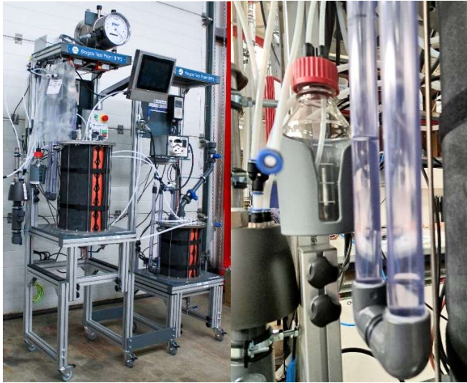
Abbildung 4 Fertiggestellte Laboranlage (links) vor Auslieferung und Detailansicht Gasabführung (rechts)
