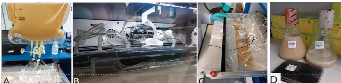
Abbildung 15 1 L hEGF Produktion im Cell-tainer. A: 1 L Lysat; B, C: Cell-tainer; D: Konzentriertes hEGF nach der Lyse der Mikrosomen.
