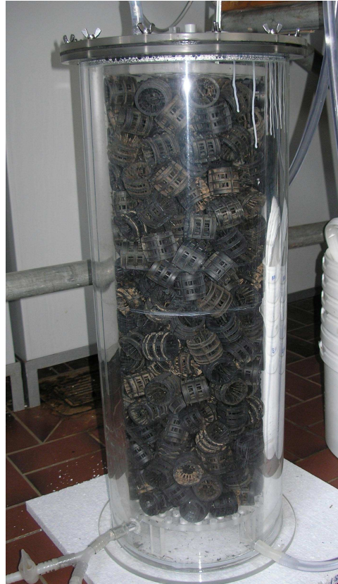
Abbildung 4: Festbettmethanreaktor mit loser Schüttung der Aufwuchsträger Bioflow 40
