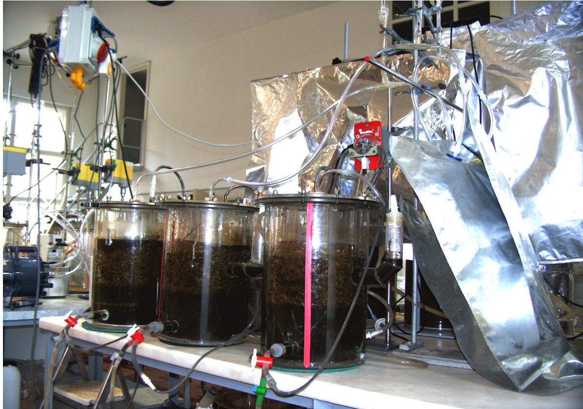
Abbildung 23: Drei 10 Liter-Acrylglas-Fermenter der vier unterschiedlichen Versuchsvarianten der Untersuchung des Einsatzes von Enzymen
