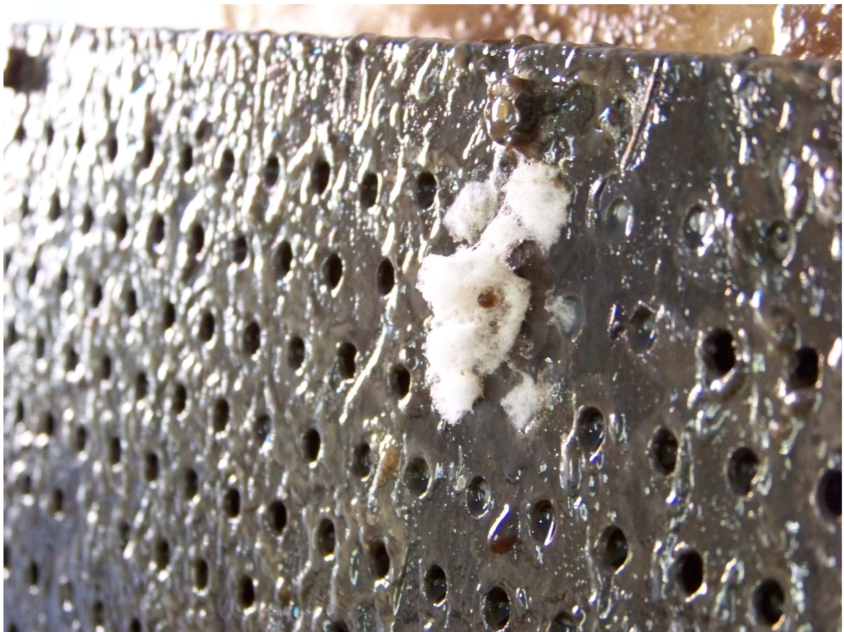
Abbildung 12: Pilzmyzel ( Geotrichum candidum ) am Deckel der Fahrweise der offenen Hydrolyse (Quelle: AG Mikrobiologie, ATB)
