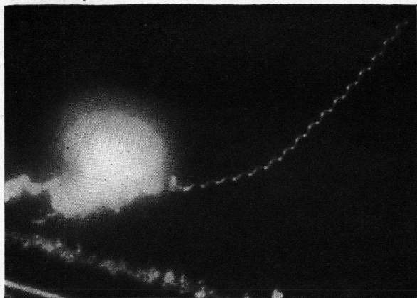
Bild 5. Spanlocke aus Glas, geschnitten mit Sinter-Rubin. Vergr. 1000 \times . Auffallende Dunkelfeld-Beleuchtung.
