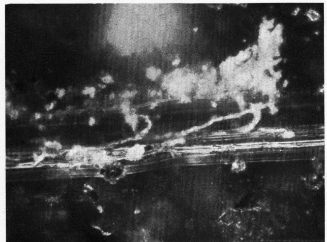
Bild 18. Ritzspur und Spanlocke an Sinterzirkonerde ( \text{ZrO}_2 ), erzeugt mit Diamant.
