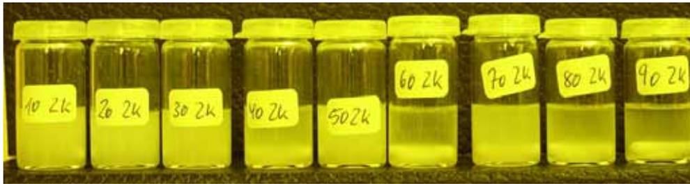
**Abbildung 11: 2K-ZOVAN-Lacke mit MPTS/FTS Kokondensaten in Konzentration 4F. Von links nach rechts: 10 Mol%MPTS:90 Mol% FTS bis 90 Mol% MPTS:10 Mol% FTS.**
