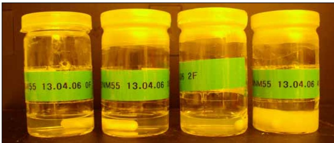
**Abbildung 3: BNM-Komponente von BNM Charge 5 (Tabelle 3) in Ethanol mit (von links nach rechts) 0F, 1F, 2F und 4F Gehalt an F-Komponente nach 14 Tagen Standzeit. 2F mit beginnender Trübung, 4F bereits geliert (klarer Überstand, trübe Gelphase).**
