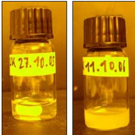
**Abbildung 4: Aussehen des angemischten 2K-Beschichtungssystems 0F aus BNM-Komponente aus Charge 1 (links, transluzent) und Charge 10 (rechts, trüb). Kenndaten der BNM Chargen siehe Tabelle 3**
