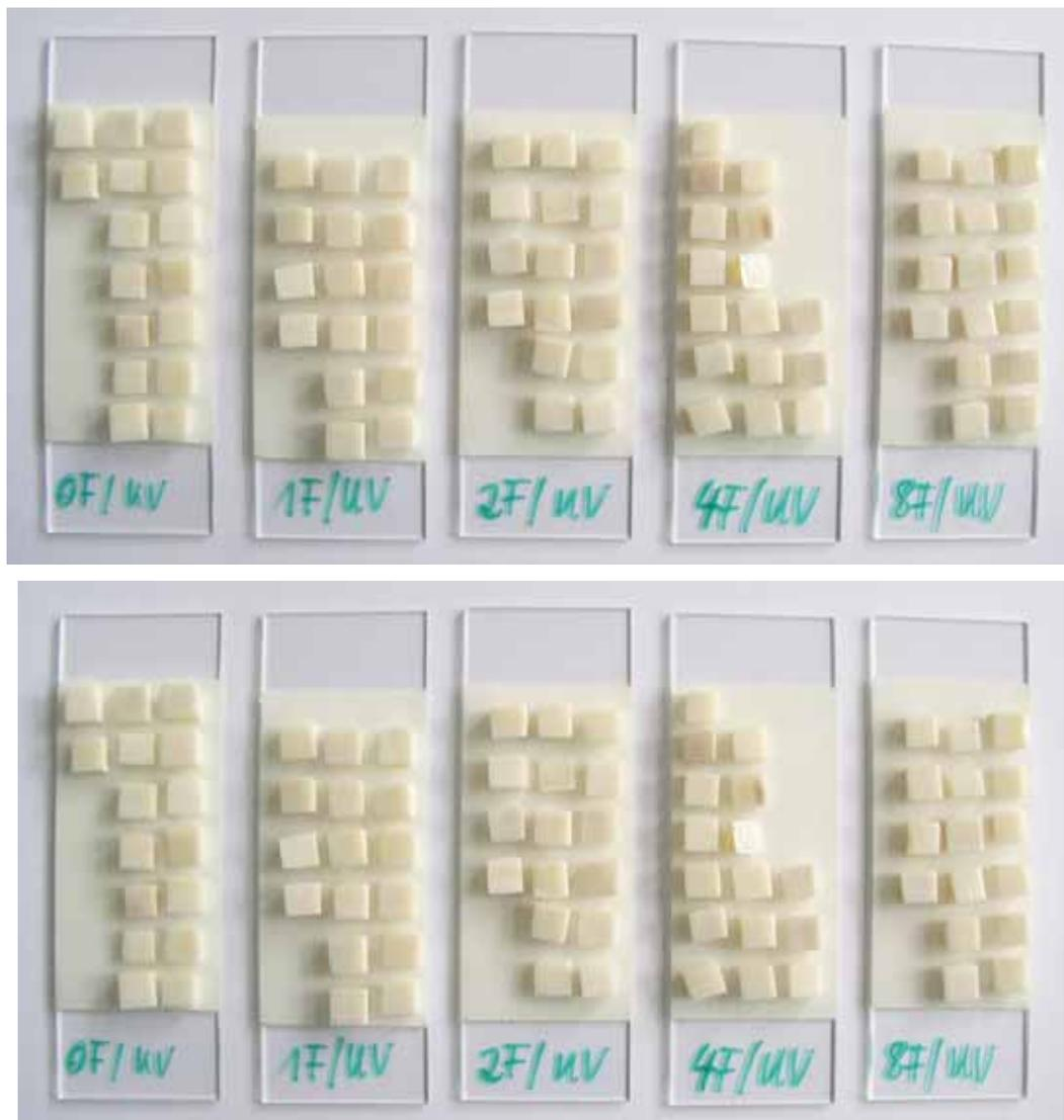
**Abbildung 13: Zahnschmelzstücke Serie #1 vor (oben) und nach (unten) Beschichtung und UV-Härtung.**
