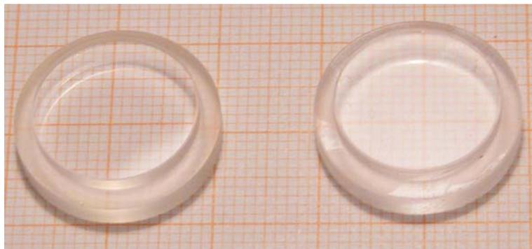
Fig. 54: ADCS/ SCB - dotiertes PDMS, Stufenscheibe, Schichtdicke 5,1  $\mu\text{m}$  Opazität 2,15 (AQ153p)
