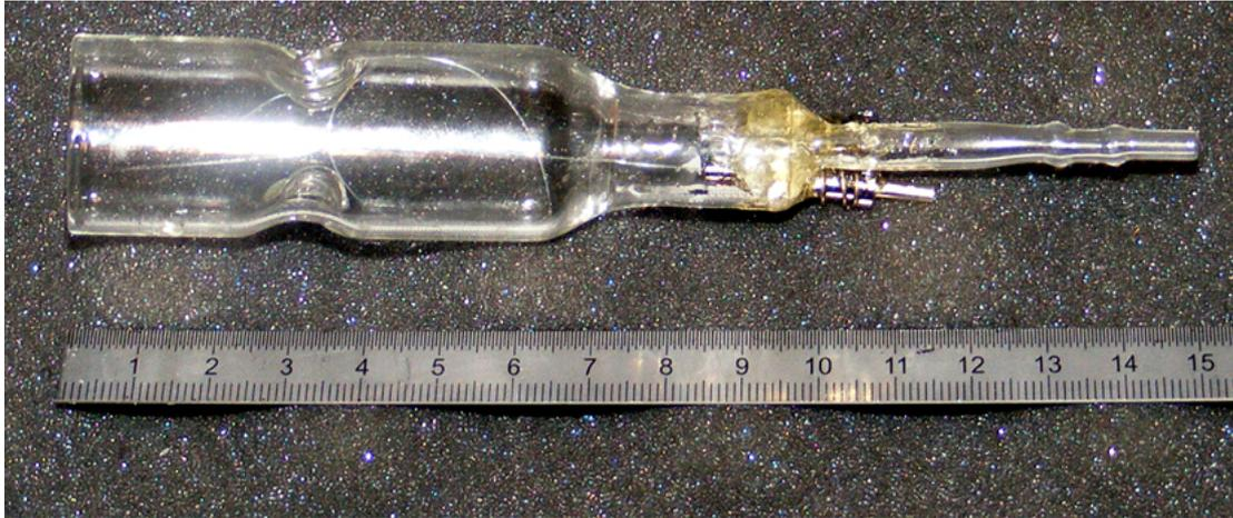
Fig. 37: Sensor AQ27 mit mehrfach im Glasgehäuse gebrochener Sensorfaser)
