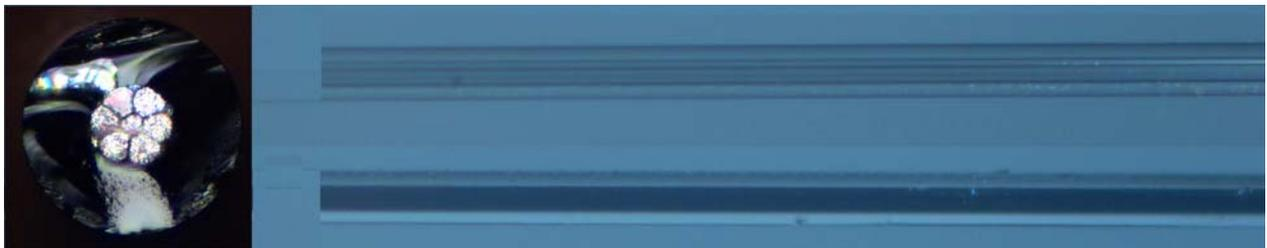
Fig. 38: Mehrkammerfaser, gefüllt mit Roses Metall.
