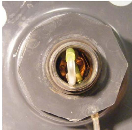
Fig. 57a: Integration eines Planarsensors für direkten Wasserkontakt im Anschlussflansch
