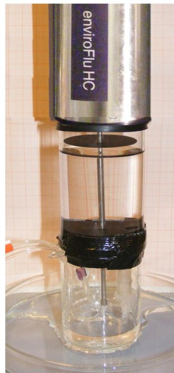
Fig. 58b: Ansicht Schwallkammer mit EnviroFlu HC als Sensor\*
