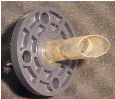
Fig. 25: Sensor AQ14 nach einer Messung in Formazin+ Eisenoxid
