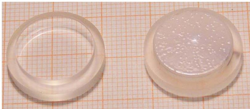
Fig. 53:  $\text{TiO}_2$ -dotiertes PDMS, Stufenscheibe, Schichtdicke 25  $\mu\text{m}$  Opazität 3,1 (AQ56p)
