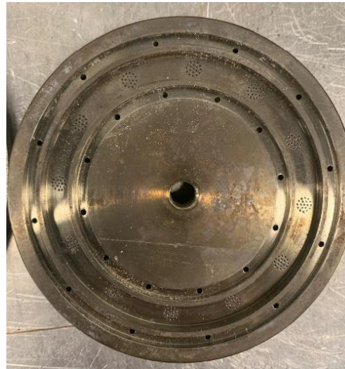
Abb. 1.4: Spinn-Pack für das Schmelzspinnen von PLLA und PDLA mit einer Insel-im-See-Konfiguration
