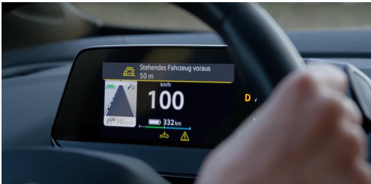
Abbildung 3: Beispielhafte C-ITS Warnung für ein stehendes Fahrzeug [35]
