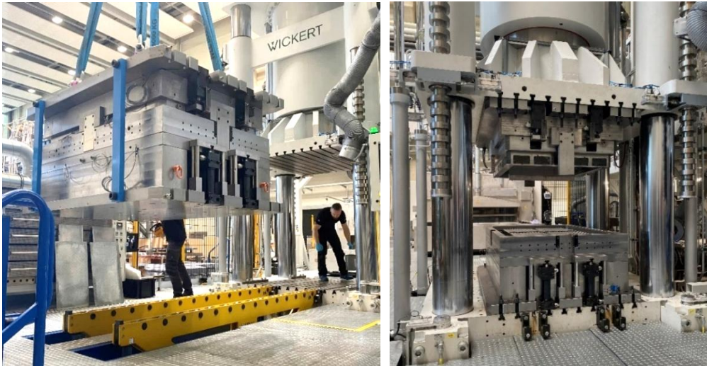
Abbildung 10: Einbau des 16 t schweren Batteriegehäusewerkzeuges in die Pressenanlage im Technikum der Professur Strukturleichtbau und Kunststoffbearbeitung
