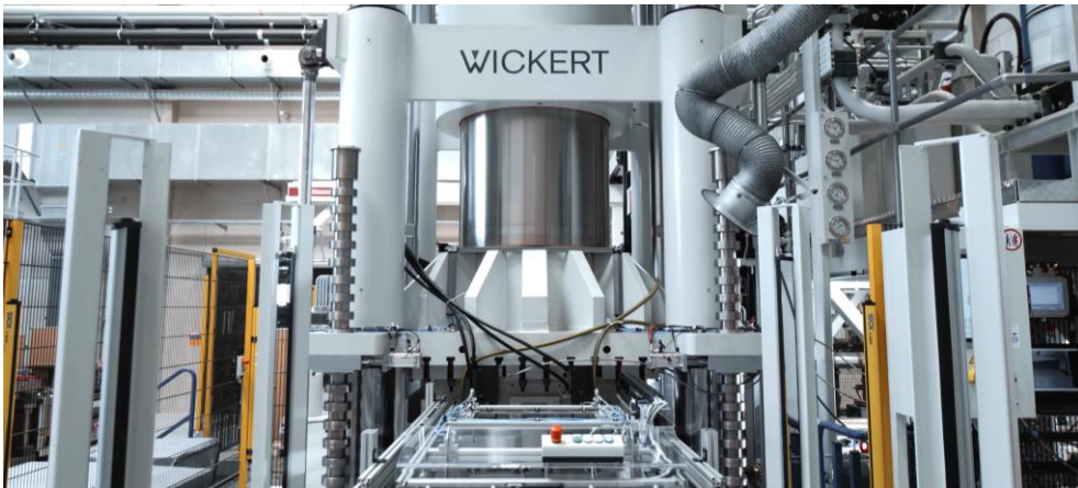
Abbildung 16: Fließpressen der Warmplatten bestehend aus GMT und UD zu einem endbearbeitungsnahen Bauteil
