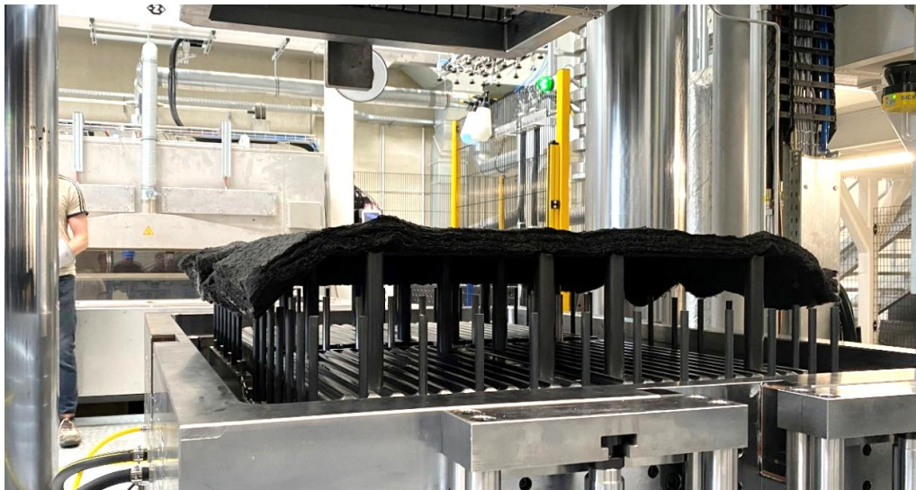
Abbildung 11: Prüfung der Funktionsweise der Auswerferstifte im Gesenk für die manuelle und spätere automatisierte Bauteilentnahme mittels Umgreifens bzw. Unterfahrens
