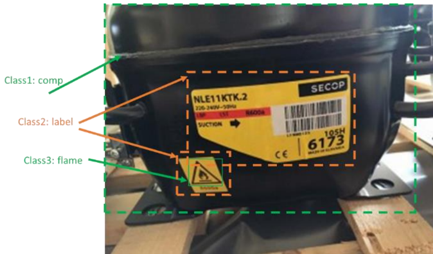
Abbildung 21: Beispiel für die schrittweise Erkennung der Kompressorenkennzeichnung
