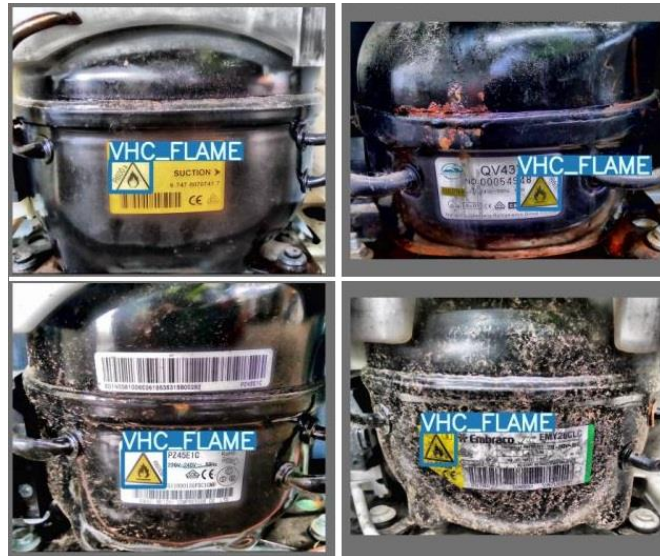
Abbildung 15 - Erkennung von Warnzeichen W021, die für das entflammbare VHC-Kältemittel repräsentativ sind
