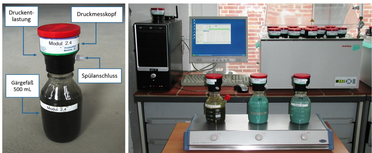
Abbildung 4: Versuchsaufbau für die Durchführung der diskontinuierlichen Vergärungsversuche (Batchtest)
