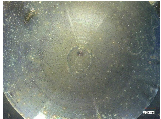
Bild 82: Versuchsergebnis des Versuchs rDA65df16, Kraftspitzenwerte und Lastabfall unter Verwendung der Maximalkraft (links) sowie Bild der anrissfreien Prüfzone (rechts).
