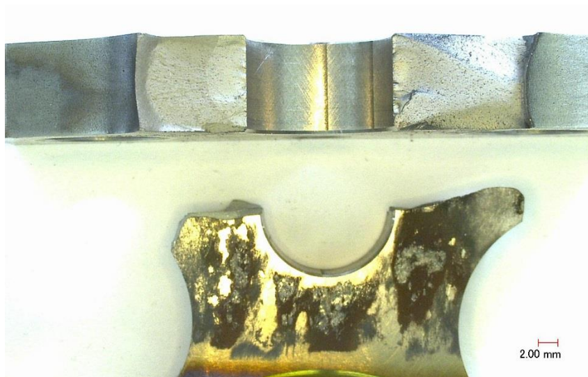
Bild 68: Detailaufnahme der Draufsicht der Bruchfläche, Versuch rDA65df5.
