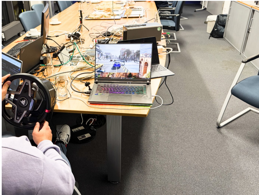
Abbildung 37: Simulation des manuellen Fahrens mit Lenkrad und Pedalen, gesteuert über DNA-Prozessoren auf der RazorMotion-Plattform.
