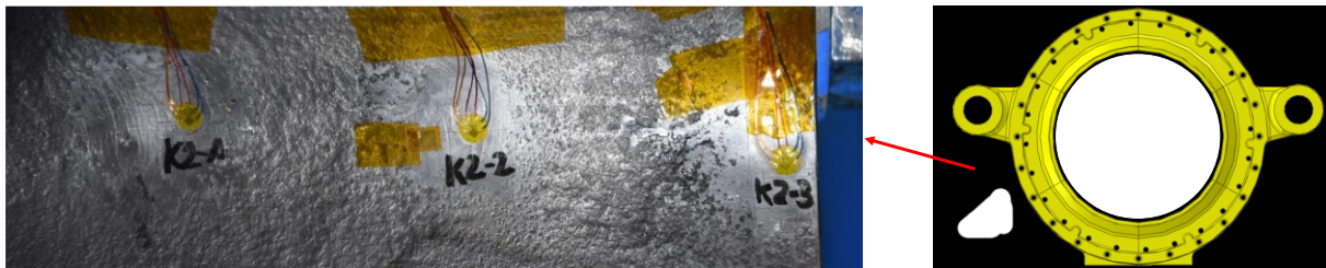
Abbildung 115: Exemplarische Abbildung von drei DMS in einer Kerbe (links) und Markierung der Kerben (rechts)
