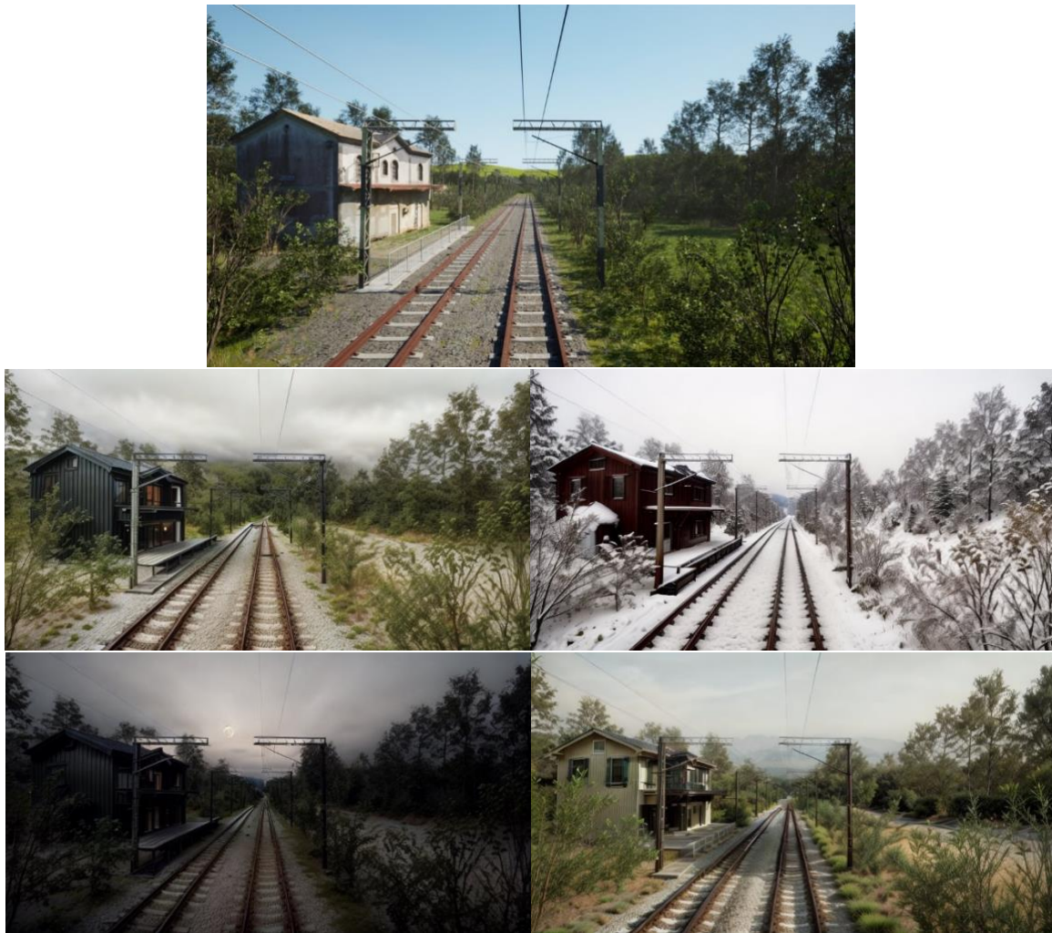
Abbildung 2 – Oben: Das durch den Simulator generierte Bild. Unten: Vier durch GenKI nachverarbeitete Bilder. Allen vier Bildern liegen die gleichen Eingabebilder zu Grunde (Simulatorbild, Segmentierungsmap, Tiefenmap), haben jedoch unterschiedliche Textbeschreibungen zur Stilveränderung.
