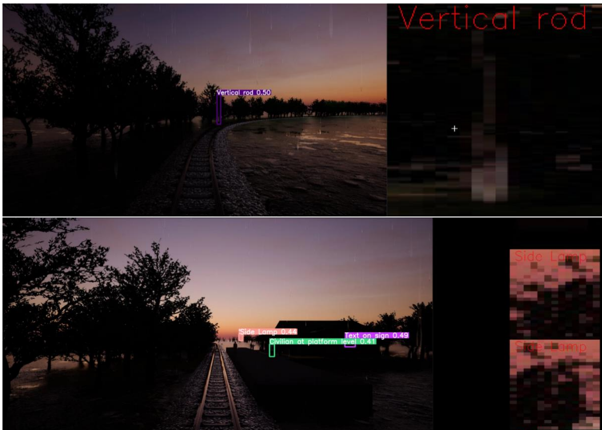
Abbildung 3 – Oben: Ein fälschlicherweise als vertikale Stange erkannte Region wird vom Simulator und Evaluationssystem als Fehler erkannt. Unten: Analog mit nicht-existenten Lampen.
