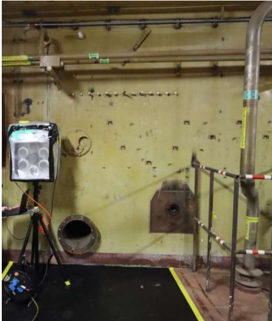
Abb. 6-2: Beispiel für eine Validierungsmessung mit dem eingehausten RSL7 im Kontrollbereich des KKR
