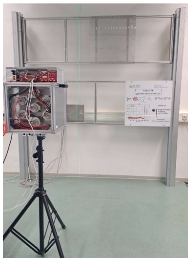
Abb. 4-2: VS „GARAY TF“ – Aufbau im Labor Strahlentechnik der HSZG mit Comptonkamera RSL7 im Vordergrund.
