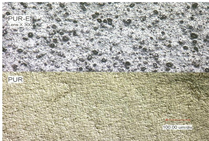
Die Auflösung des Lichtmikroskops ist zu gering, um den Einfluss der Ionenimplantation darzustellen. Die weitere Charakterisierung der Oberflächentopografie der modifizierten PUR-Oberflächen wurde deshalb mittels Atomkraftmikroskopie (AFM) fortgesetzt.
