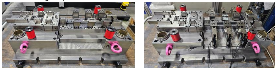
Abbildung 28 Rüstkonfiguration des Versuchswerkzeugs mit passiven (l.) und aktiven Hochhebern (r.)
