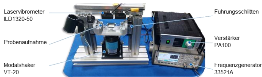
Abbildung 10 Aufbau des Prüfstands zur modalen und transienten Anregung von Anbindungen
