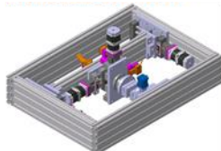
Abbildung 9 Schematische Beschreibung der Komponenten Prüfstand zur mehrachsigen Anbindungsbelastung
