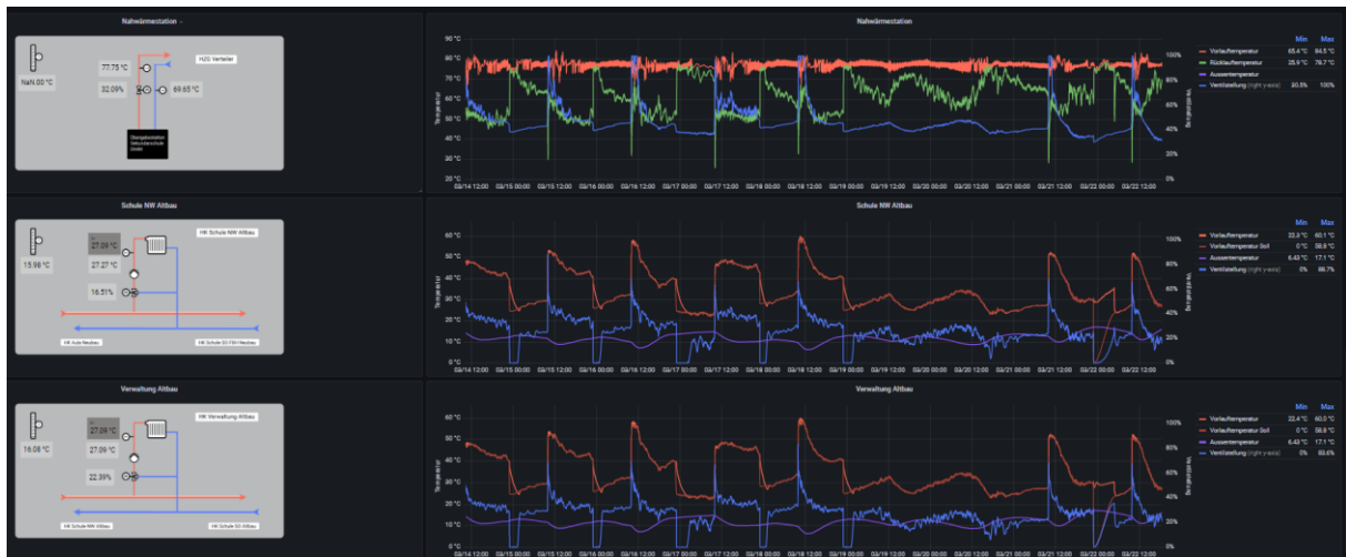
Abbildung 21 : Livedaten in Auszüge aus Anlagenplänen eingebettet und historische Daten als Zeitreihen, Heizkreise der Sekundarschule Kirchhellen
