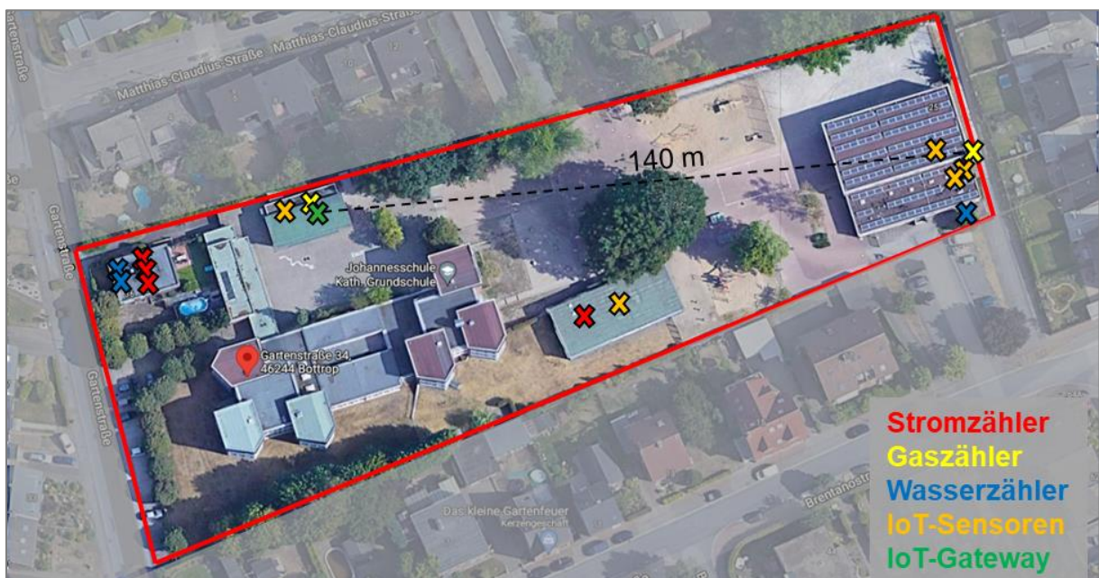
Abbildung 7: Installierte Zähler und Sensoren über das Gelände der Matthias-Claudius- und Johannes-Schule
