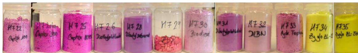
Abbildung 1: Fotos getrockneter Melamin-Formaldehyd Mikrokapseln mit verschiedenen Kernmaterialien von links nach rechts: Captex 100 ® , Captex 300 ® , Captex 8000 ® , Diethylphthalat, Dibutylsebacat, Red Dye Penetrate, Biodiesel, Dibutylphthalat, Diisopropylnaphthalen, Hydr. Terphenyl, Zyglo ZL-2C ® , Zyglo ZL-27A ®
