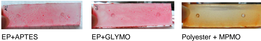
Abbildung 14: Matrixharz mit modifizierten MF-Mikrokapseln nach dem Aushärten
