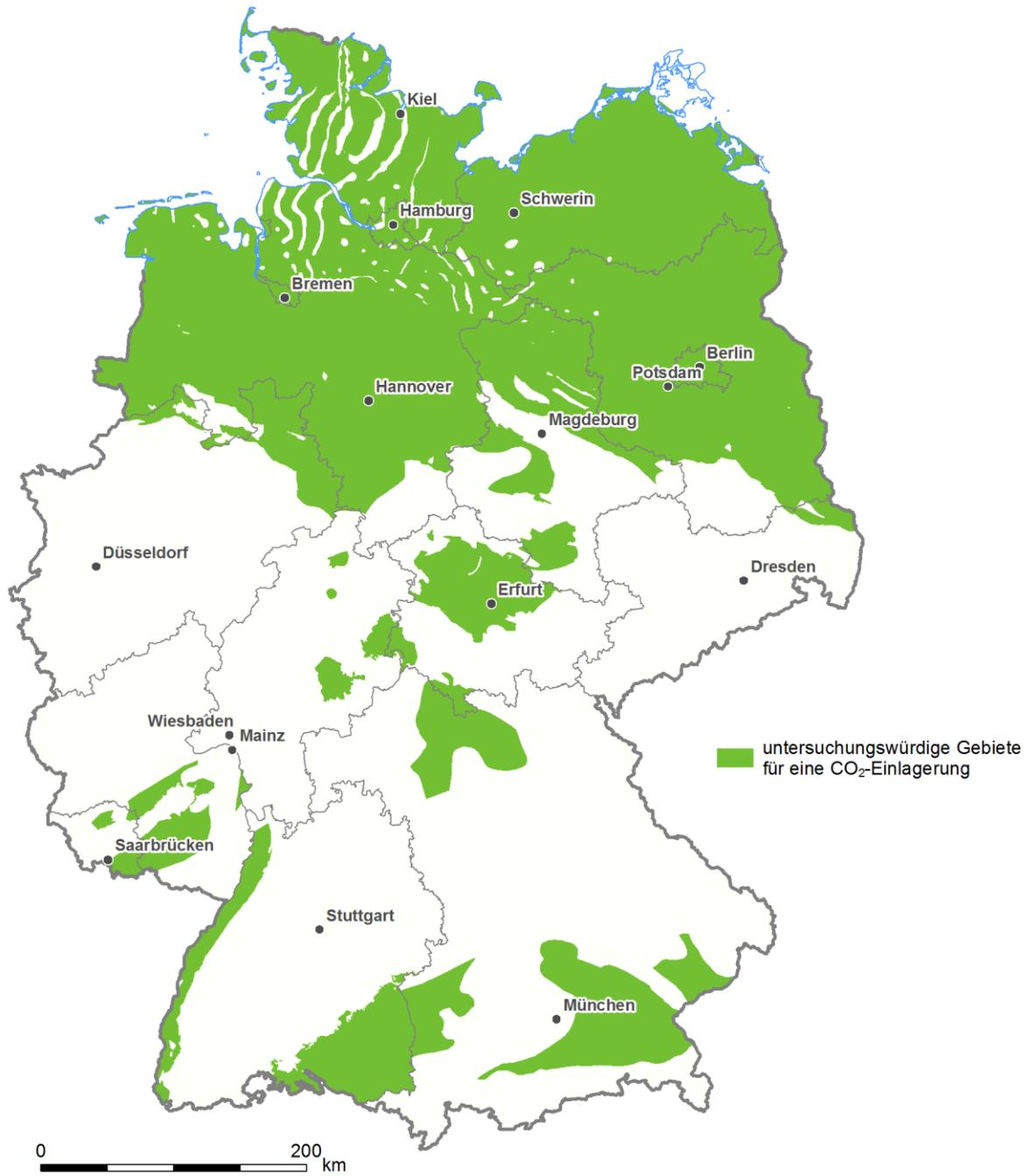
Abb. 3.10: Verbreitung der für eine CO<sub>2</sub>-Einlagerung untersuchungswürdigen Gebiete.
