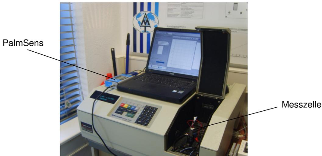
Abb. 17 Messplatz mit UV/VIS-Photometer und elektrochemischem Messgerät PalmSens
