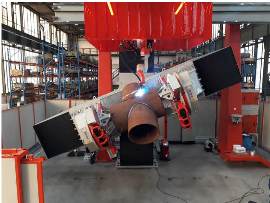
Bild 4: Schweißanlage für die automatisierte Fertigung von Rohrknotten
