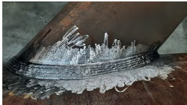
Bild 29: Fertigung manuelle Fertigung von KLnoten im Maßstab 1:1,5 mit zugehöriger Schweißnahtgeometrieausbildung
