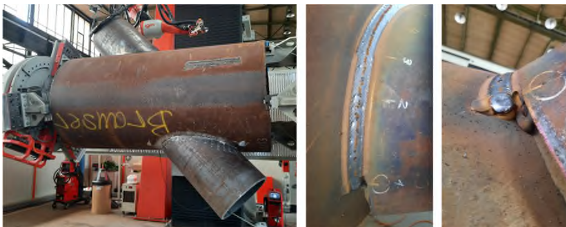
Bild 16: Testschweißungen an einem Knoten im Maßstab 1:1 mit Darstellung der Schweißnahtgeometrie und Stützstellen
