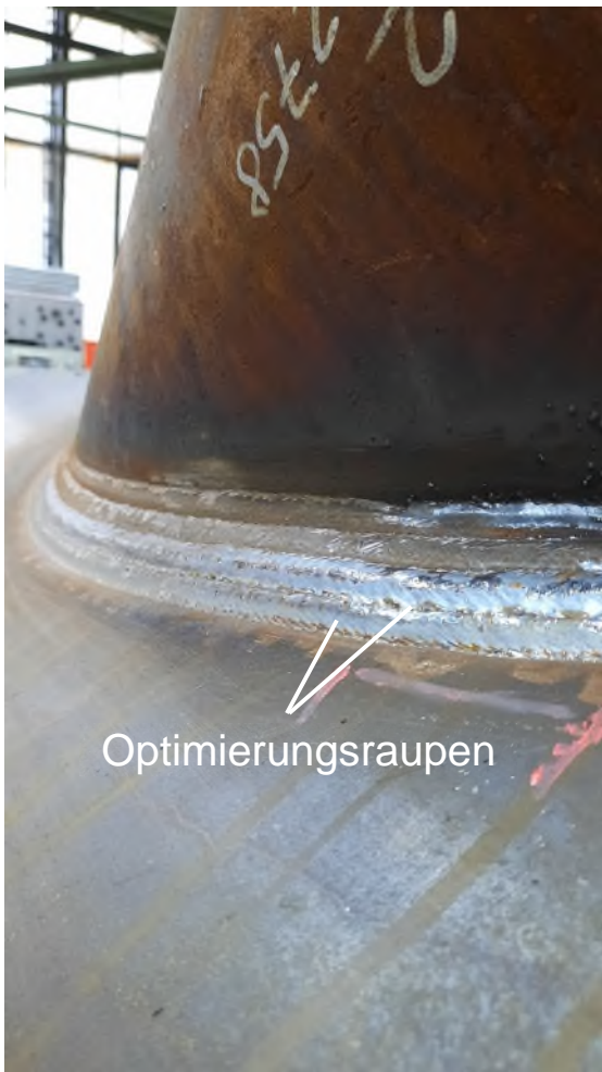
Bild 23: Fertigung des Knotens 3 (von 3) im Maßstab 1:1 (oben), Geometrie der Schweißnaht inkl. Darstellung der Optimierungsraupen (unten)
