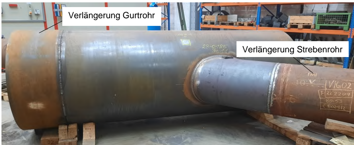
Bild 24: Verlängerungen von Gurt- und Strebrohre (manuelle schweißtechnische Fertigung)
