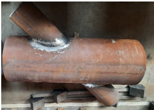
Bild 29: Fertigung manuelle Fertigung von KLnoten im Maßstab 1:1,5 mit zugehöriger Schweißnahtgeometrieausbildung
