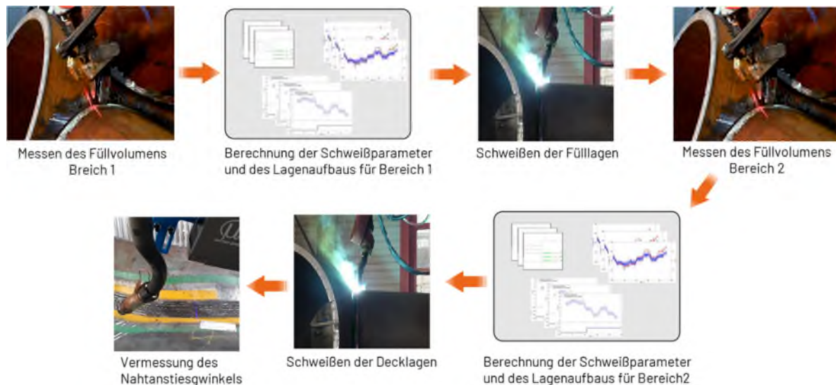
Bild 8: Darstellung des Konzeptes zum adaptiven Schweißen von Rohrknotten
