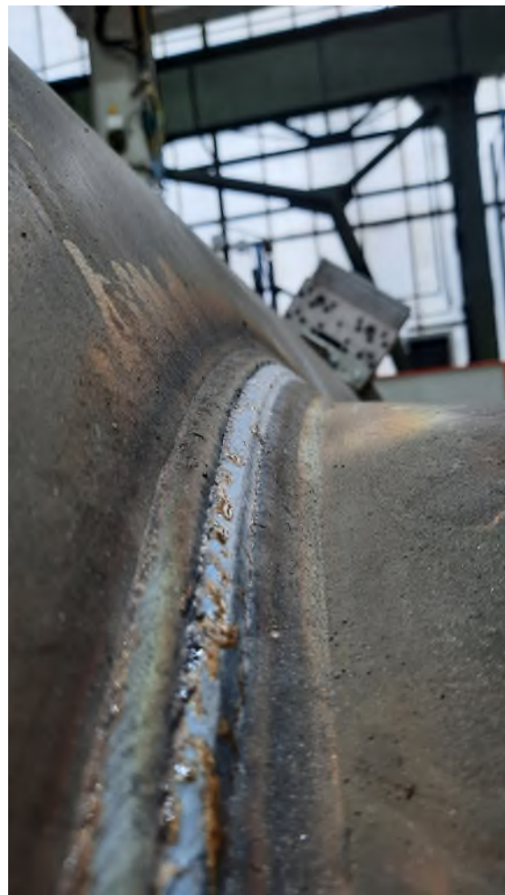
Bild 23: Fertigung des Knotens 3 (von 3) im Maßstab 1:1 (oben), Geometrie der Schweißnaht inkl. Darstellung der Optimierungsraupen (unten)
