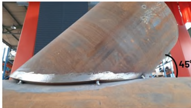
Bild 5: Darstellung der Schweißnahtvorbereitung und Schweißnahtgeometrievorgaben; Auszug aus DNVGL-RPC203 [9] für beidseitig geschweißte Anschlüsse
