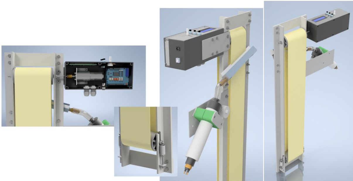
WP2_1: Inventar-Entwurf des Skimmers mit allen Komponenten: Wischer, der Motor, die Walze, die Entwässerungsrinne und das Band.
