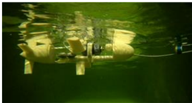
WP5_2: 1:3 skaliertes YDE-Fix-Modell bei der Erprobung im Wasserbecken der Hochschule Emden / Leer, Gerriets et al, 2021.
