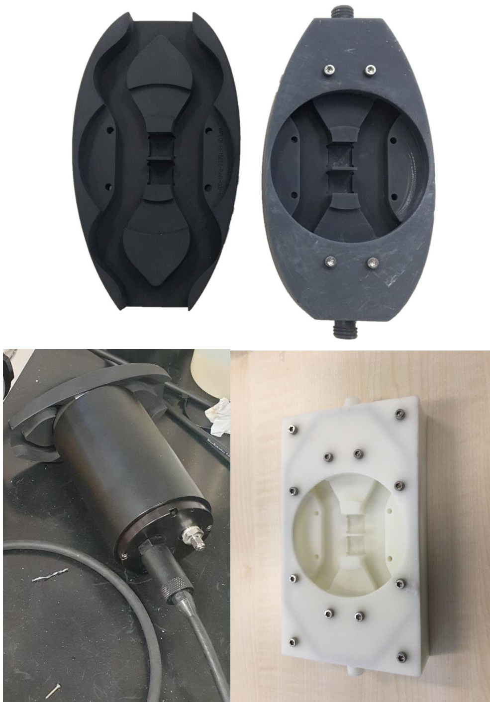
WP2_4: Das Design, das endgültige Design offen und mit Sensor und der erste Versuch MiniFluo-Kappe.
