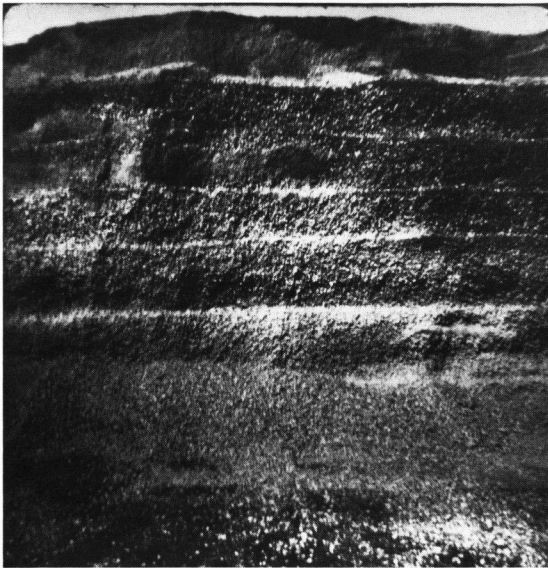
Bild 3. Schichtweiser Aufbau einer Mischhalde, die im unteren Teil schon eine recht gute Vermischung des Calumite-Rohstoffs erkennen läßt.
