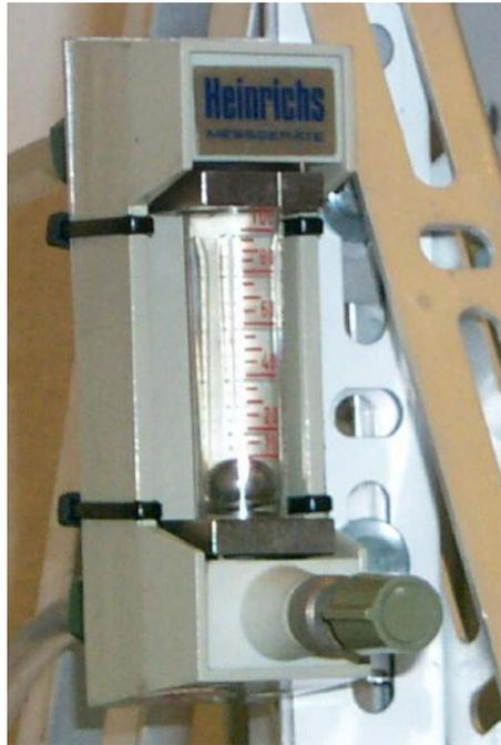
**Abb. 12:** Schwebekörper-Durchflussmesser für die Katolytversorgung
