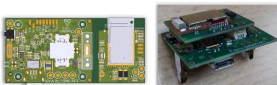
Abbildung 11: Darstellung der Elektronikkomponenten im gleichen Maßstab. (Oben) Generische Versionen des Teensy 4.1 sowie des Adafruit Bluefruit LE UART Friend. (Mitte und unten) Unter- und Oberseite der auf die für den Anwendungsfall notwendigen Komponenten reduzierten und teilweise neu angeordneten Versionen beider Ausgangsplatinen
