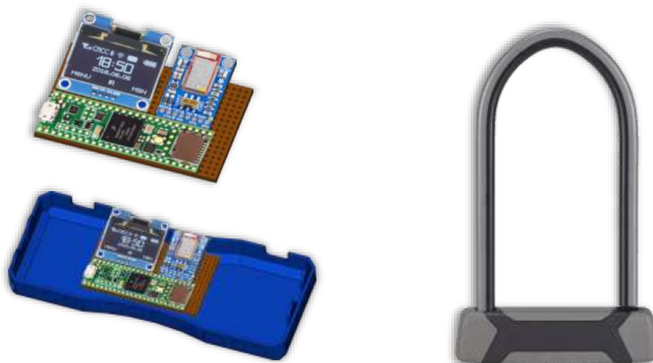
Abbildung 10: Vergleich unterschiedlicher Schließlösungen und Prototypen. (Links oben) Entwicklungsprototypen des Chainlock-Systems mit Teensy 4.1, Bluetooth-Modul und Display. (Links unten) Beispielhafte Integration der Elektronik in die Schlosskomponente eines ABUS Fahrradbügelschlosses. (Rechts) Darstellung eines kommerziell vertriebenen Fahrradbügelschlosses mit konventionellem Schließzylinder
