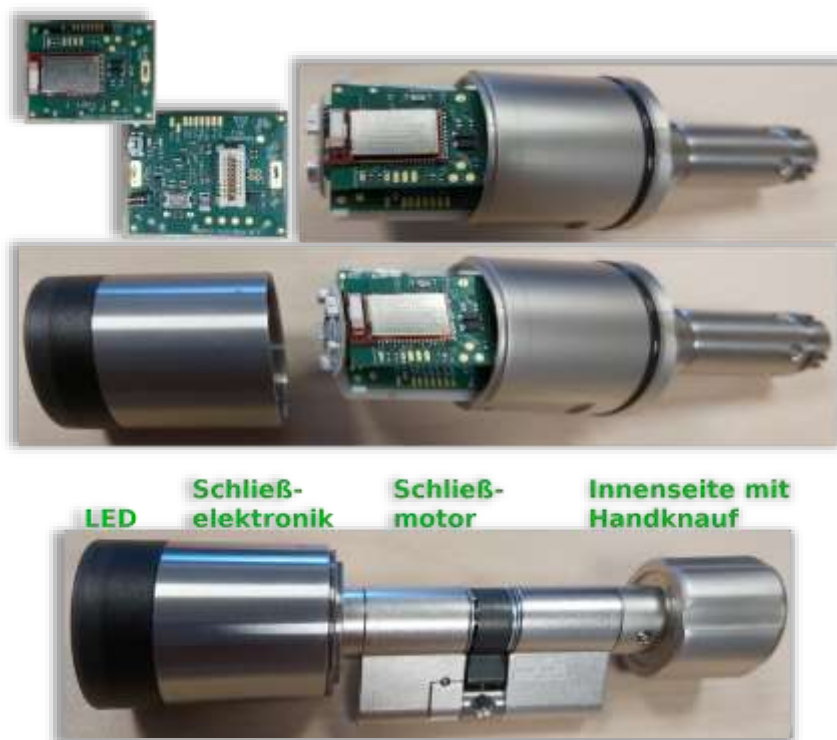
Abbildung 15: Komponenten und Montageschritte eines Chainlock-basierten Schließzylinders. (Oben links) Einzelne elektronische Platinen. (Oben rechts) Zusammengesetzte Steuereinheit mit mehreren Lagen und integriertem Batteriefach im Knaufkorb. (Mitte) Einbau der Steuereinheit in das Schlossgehäuse mit aufgesetzter Knaufkappe. (Unten) Fertig montierter Schließzylinder.
