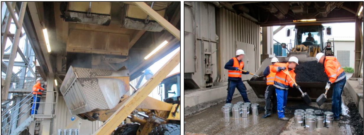
Bild 4-8: Beladung der Radladerschaufel mit Asphaltmischgut (links) sowie Entnahme der Asphaltmischgutproben durch vier Probennehmer
