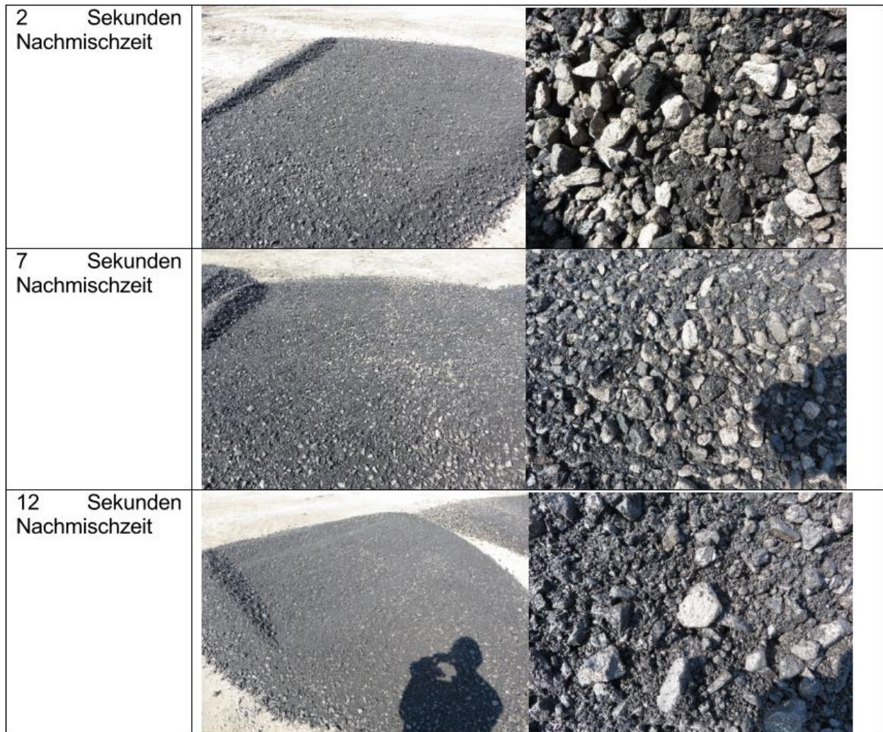
Bild 4-6: Visuelle Erfassung des Homogenisierungsgrades für Mischungen am Asphaltmischwerk unter Variation der Nachmischzeit, Teil 1 [STEPHAN, 2019]
