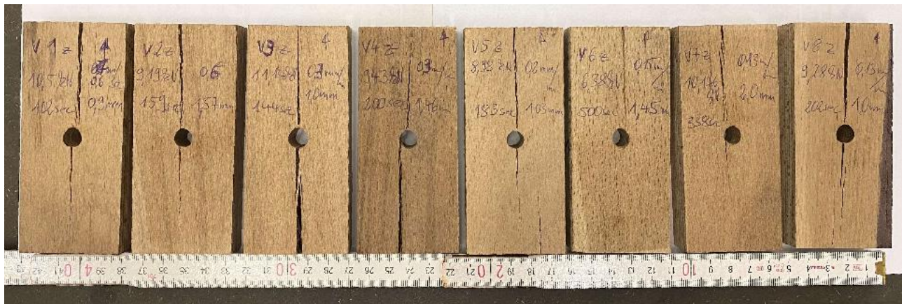
Abbildung 32: Ansicht einer Versuchsserie zur Lochleibung nach dem Versuch mit Stabdübeln Durchmesser 8 mm. 6 von 8 Prüfkörpern spalten von der belasteten Seite her auf, 2 von 8 von der unbelasteten Seite.
