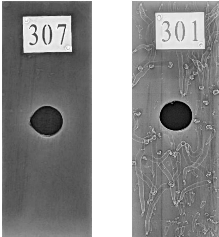
Abbildung 195: Röntgenaufnahmen von acetyliertem Buchen-LVL nach dreijähriger Bewitterung (links) sowie von unbehandeltem Buchen-LVL nach einjährigem Kontakt im Meerwasser (rechts).
