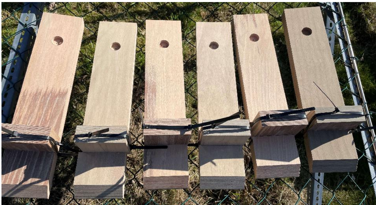
Abbildung 20: Acetylierte und unbehandelte LVL Bauteile zu Freibewitterung im Außenbereich (Start Mai 2025).
