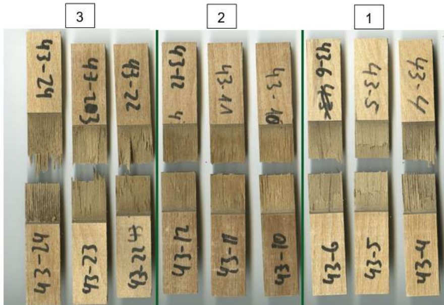
Abbildung 13: Prüfkörper (acetyliertes Buchen-LVL verklebt mit PRF-Klebstoff) nach Prüfung der Längszugscherfestigkeit in Anlehnung an EN 314-2 nach Kochwechselfest (1), Wasserlagerung (2) und Konditionierung bei 20°C und 65% rel. Luftfeuchte (3)
