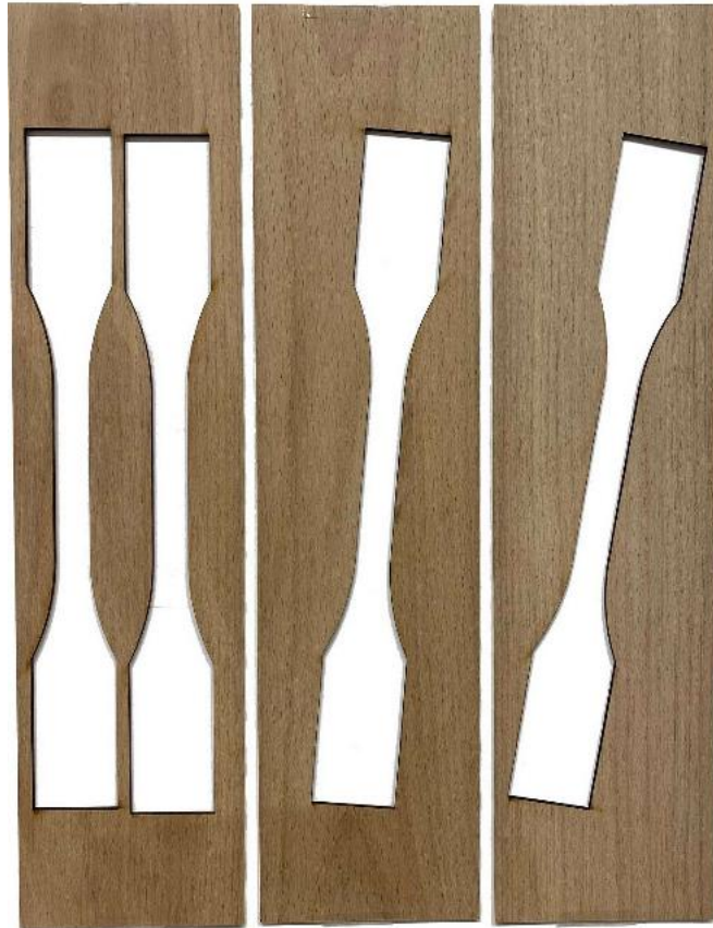
Abbildung 7: Mit einem Lasercutter wurden aus den Furnieren die Rohprüfkörper ausgeschnitten.
