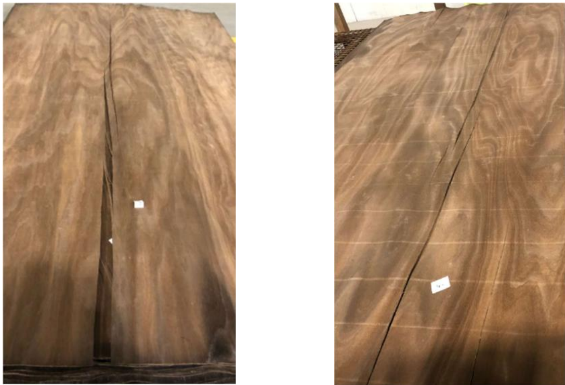
Abbildung 1: Starke Rissbildung von acetylierten Furnieren (circa in der Mitte der 1200mm breiten Furniere).
